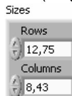
« Sizes » est un cluster contenant la hauteur des lignes (12.75 par défaut) et la largeur des colonnes (8.43 par défaut).
