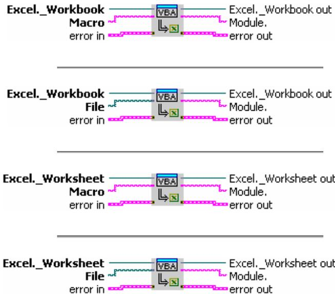
Importe une macro dans le projet attaché à un WB. Un nouveau module est créé et son nom, suivi d'un point est renvoyé dans « Module. ». Si plusieurs modules sont créés, il faut concaténer « Module. » au nom de la macro à l'entrée « Macro Name » du vi « Run macro » (cf. l'Exemple 4).
