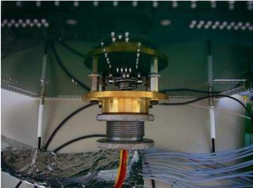
**Figure V-13 : Banc de chauffage fixé à la carte**
